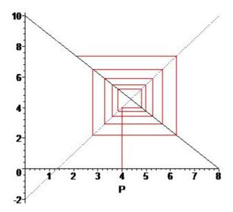
FIGURA 1. Diagrama de la telaraña con oscilaciones explosivas
