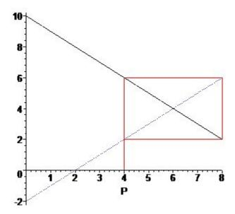
FIGURA 2. Diagrama de la telaraña con oscilaciones uniformes
